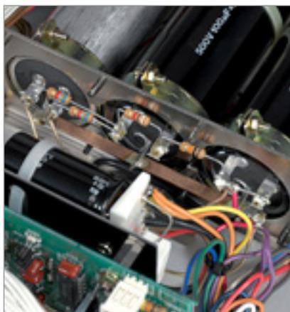
Konventionelle RC-Siebung im Netzteil des Hochpegel-Vorverstärkers
