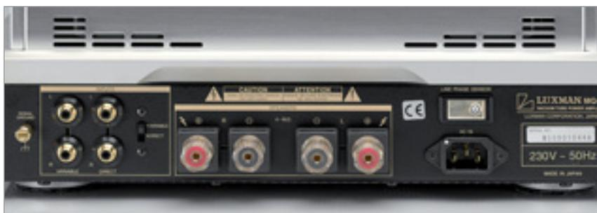
Über der Kaltgeräte-Netzbuchse befindet sich der Sensor für die Netz-„Phase“
