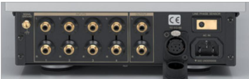
Der Vorverstärker stellt auch die Versorgungsspannungen für das Phonoteil bereit; wahlweise soll auch ein separates RIAA-Netzteil verfügbar sein
