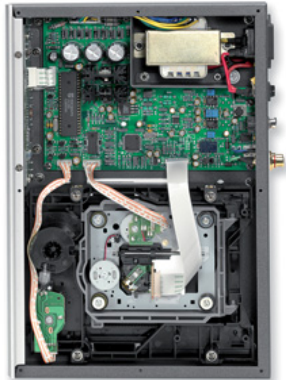
Im Player wurde das Philips-Laufwerk quasi von der Decke federnd abgehängt
