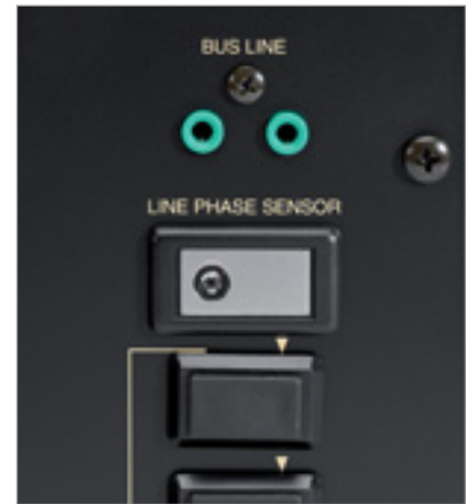
Ganz modern: „Steckerdreh“-Phasenprüfer zum Fingeraufliegen
