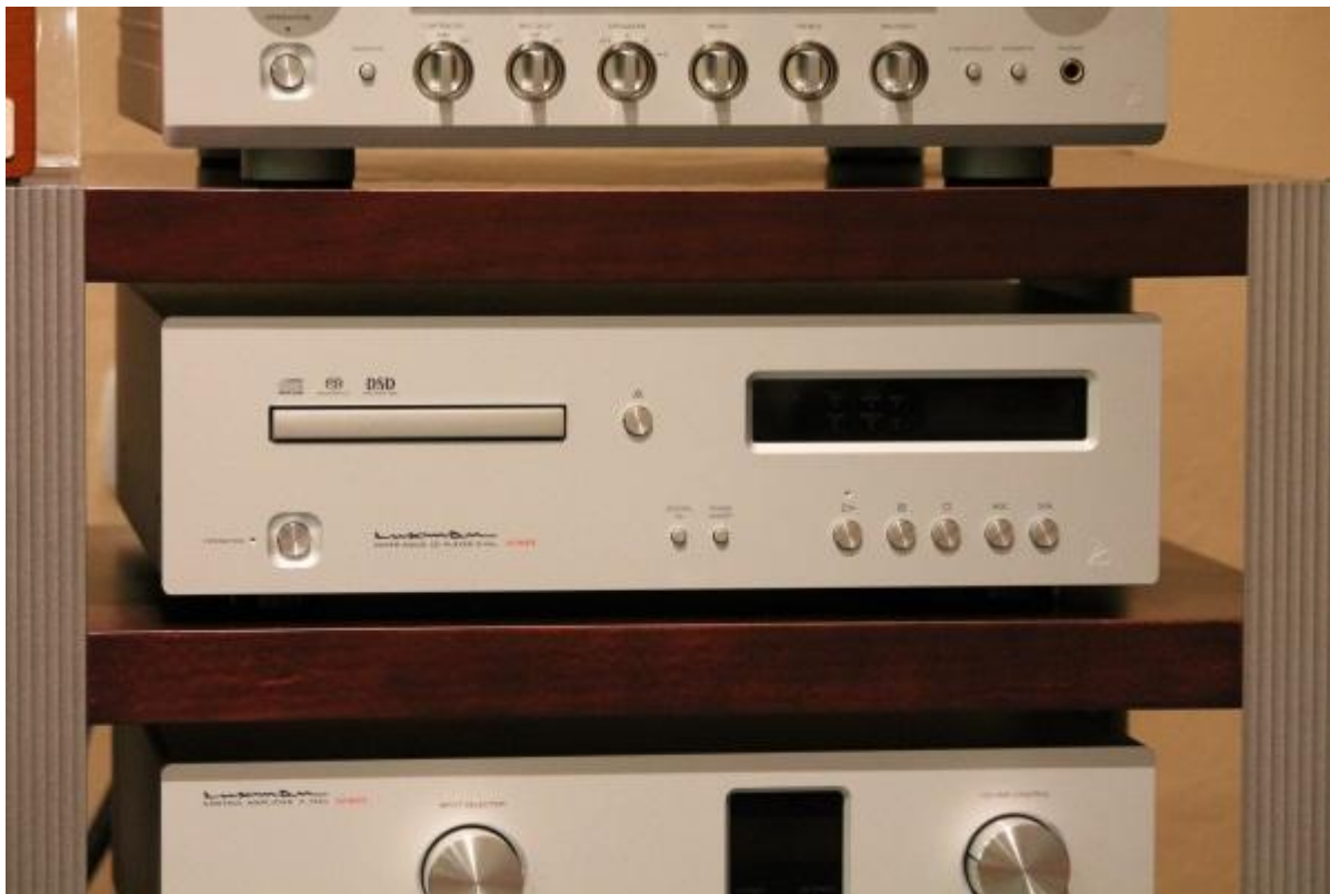
Luxman D-05u - zbrusu nový přehrávač s USB a podporou PCM a DSD
